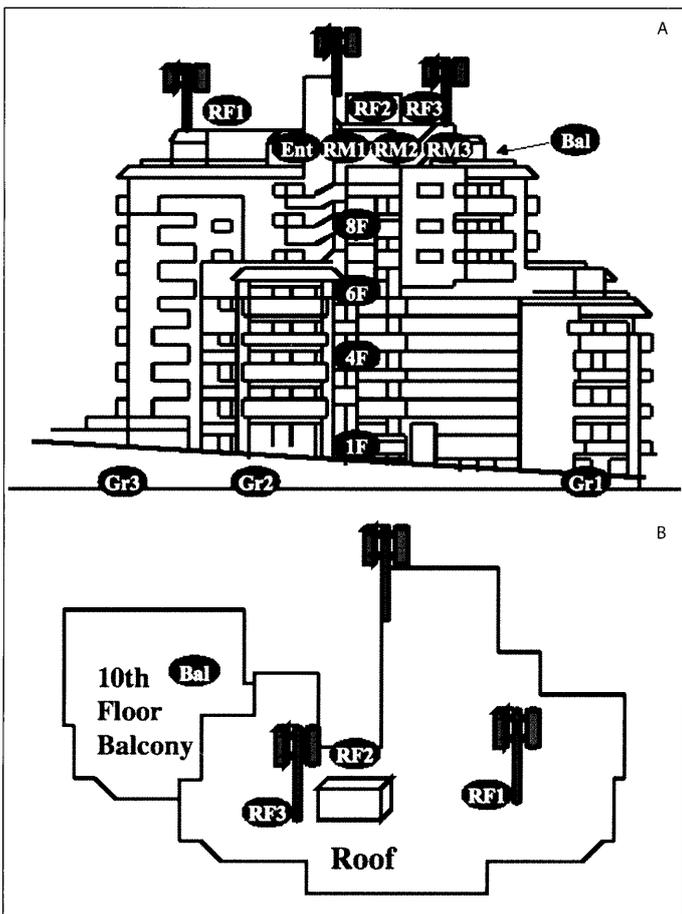
Abb. 3A und B: Messpunkte der Leistungsflussdichte der installierten Basisstationen am 24.12.2008 in Front- (A) und Aufsicht (B). Abk. siehe Tab. 1.
