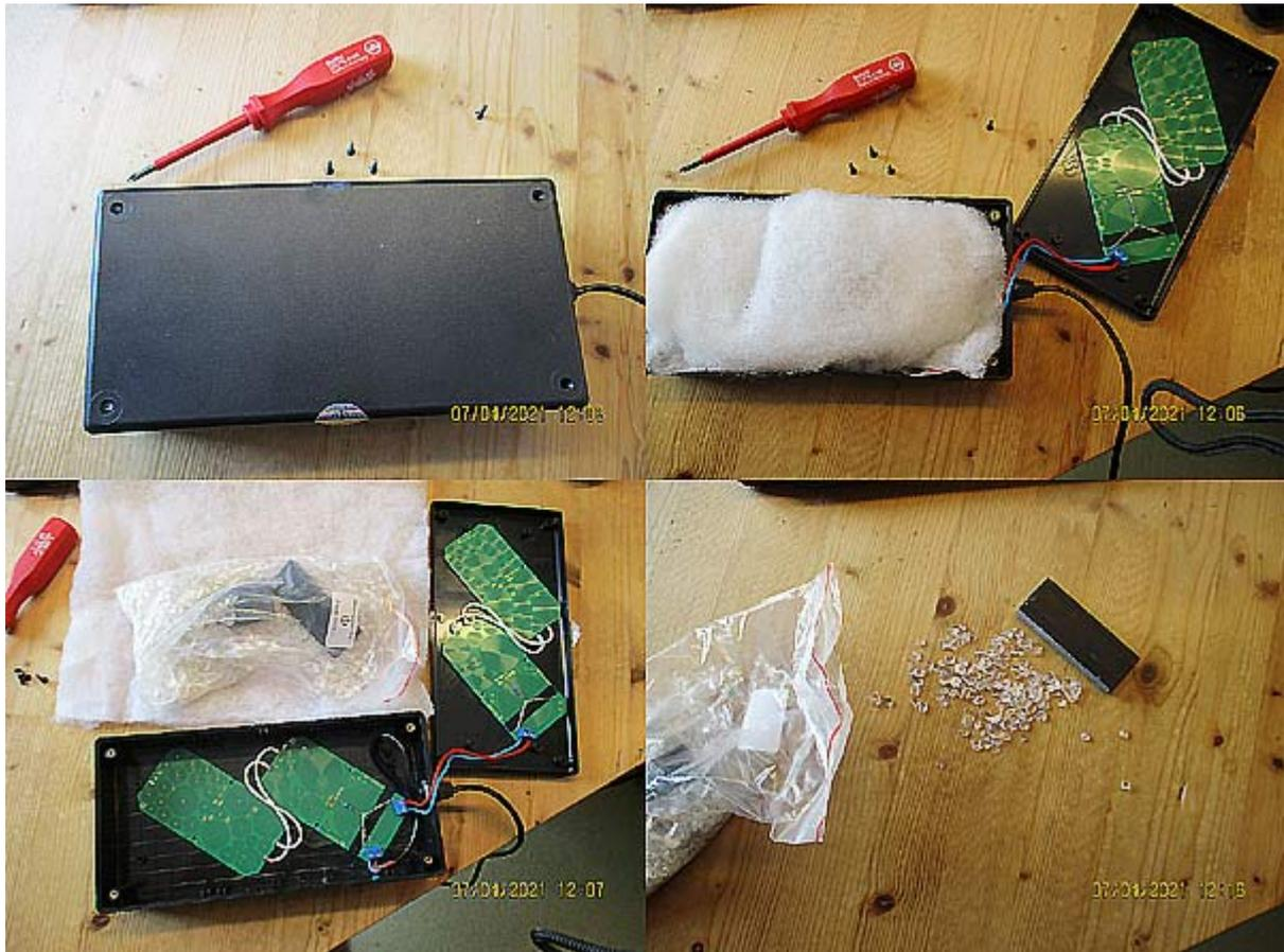
Das unscheinbare Kunststoffgehäuse ließ sich nach dem Lösen von 4 Schrauben problemlos öffnen. Zum Vorschein kamen je 2 eingeklebte Leiterplatten, (jeweils mit einer Diode und zwei Widerständen bestückt) im Deckel und im Boden sowie ein in ein Schaumstoff eingewickelter Plastikbeutel.
