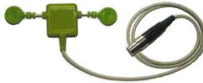
**Abbildung 14: Ambulanter automatischer elektro-physiologischer Schlafanalysator zur Aufzeichnung und automatischen Klassifizierung der Schlafstadien und der Schlafqualität mittels 3-Punkt-Stirnelektrode unter Verwendung neuronaler Netztechnik**
